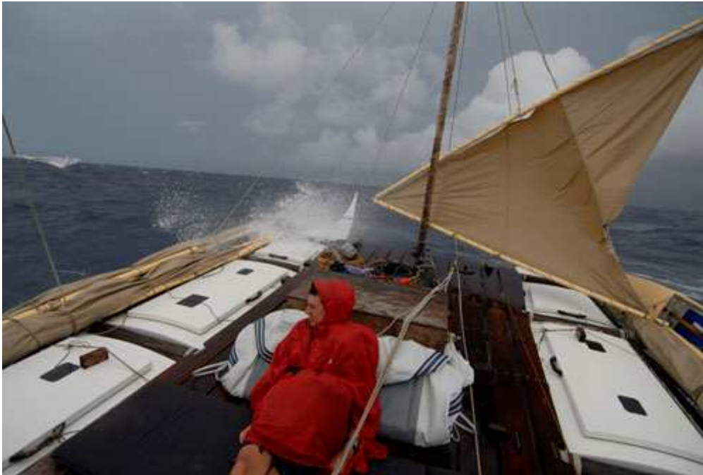
Die typischen Krebsscherensegel der nach historischem, polynesischem Vorbild gebauten Doppelrumpfboote ermöglichen hohe Geschwindigkeiten. Aber das Segeln im Sturm (Foto) ist hart. (Foto © Philipp Hympendahl)
